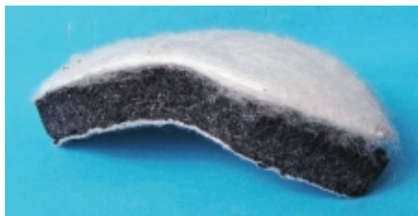
3Ms formstøbte kulfilter med Electret filtermateriale yderst.
